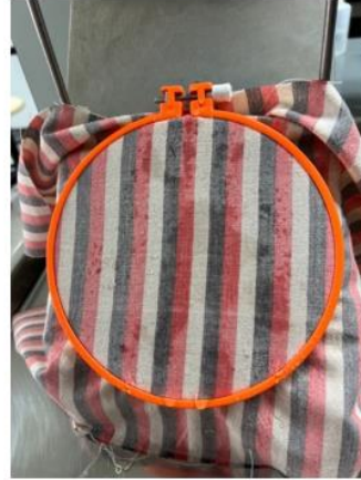
ภาพที่ 1 แสดงภาพผลทดสอบการซึมน้ำของผ้าทอพื้นเมือง
