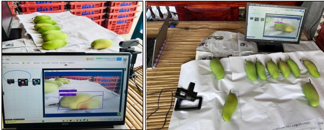
ภาพที่ 8 Customize the connection to the camera through real time operation (ที่มา: คณะผู้วิจัย, 2568)
