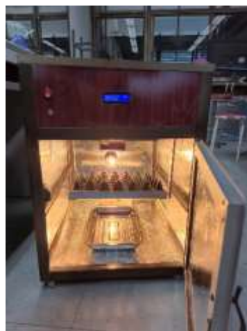
ภาพที่ 2 เครื่องฟกไข่ไก่อัตโนมัติโดยใช้ไมโครคอนโทรลเลอร์
