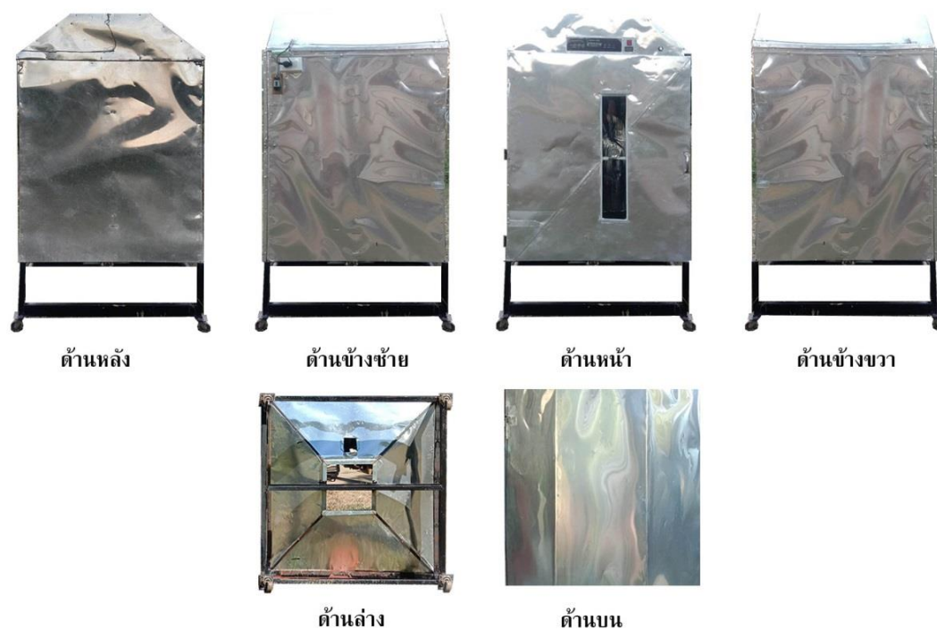
ภาพที่ 3 แสดงรูปด้านต่างๆ ของเครื่องอบแห้งเมล็ดกาแฟด้วยลมร้อน (ที่มา : ผู้วิจัย, 2568)
