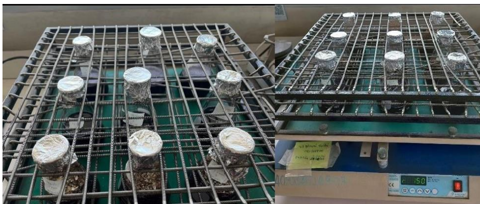
ภาพที่ 3 การดูดซับสีย้อมผ้าด้วยวัสดุดูดซับของเปลือกถั่วลิสงบนเครื่องเขย่าที่ความเร็วรอบ 150 รอบ/นาที
