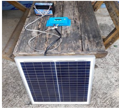
ภาพที่ 3 แสดงการต่อแผงโซลาร์เซลล์เข้ากับแบตเตอรี่ และเครื่องควบคุมการชาร์จประจุ
