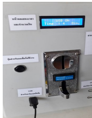
ภาพที่ 4 แสดงช่องรับเหรียญและจอ LCD แสดงสถานะ
