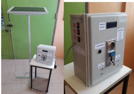
ภาพที่ 2 แสดงเครื่องชาร์จแบตเตอรี่โทรศัพท์มือถือแบบหยอดเหรียญพลังงานแสงอาทิตย์
