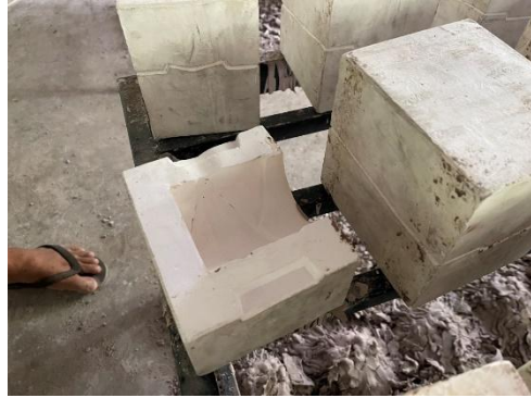
ภาพที่ 6 จัดทำพื้นที่วางแม่พิมพ์ของชิ้นส่วนแก้วและดอกโดยเฉพาะ และจัดทำแม่พิมพ์ใหม่
