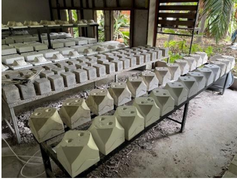
ภาพที่ 6 จัดทำพื้นที่วางแม่พิมพ์ของชิ้นส่วนแก้วและดอกโดยเฉพาะ และจัดทำแม่พิมพ์ใหม่
