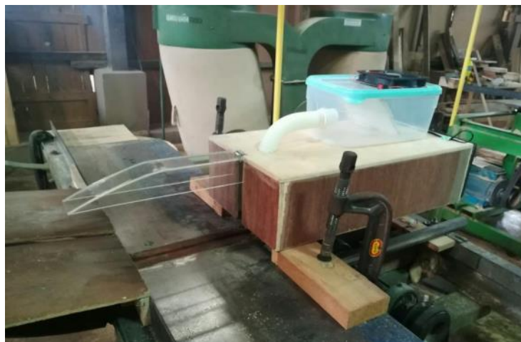
ภาพที่ 5 การทดลองใช้งานอุปกรณ์ป้องกันเสียงและฝุ่นสำหรับเลื่อยวงเดือน
