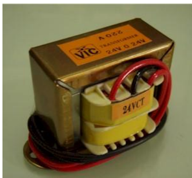
ภาพที่ 7 หม้อแปลงสำหรับวาล์วไฟฟ้าแปลงไฟจากกระแสสลับ 220 โวลต์ เป็นไฟฟ้ากระแสตรง 24 โวลต์
