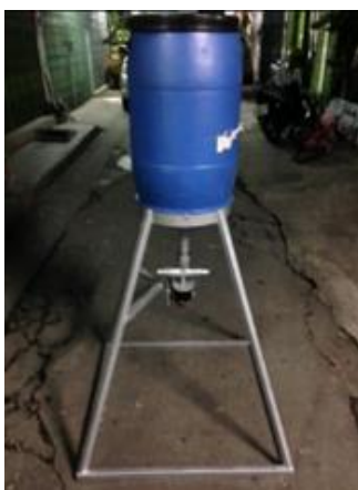
ภาพที่ 8 โครงสร้างเครื่องให้อาหารกิ้งกูดดำอัตโนมัติ
