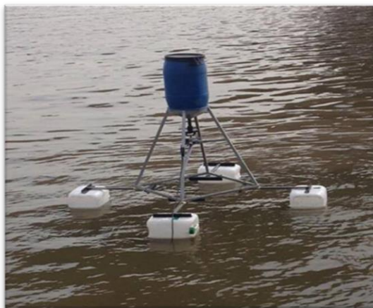
ภาพที่ 13 การทรงตัวของต้นแบบเครื่องให้อาหารกุ้งกุลาดำในบ่อเลี้ยง
