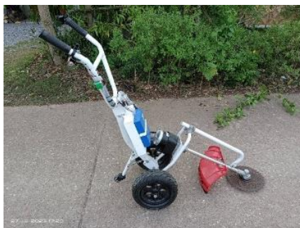
ภาพที่ 11 แสดงลักษณะของเครื่องตัดหญ้าพลังงานไฟฟ้าที่เสร็จสมบูรณ์
