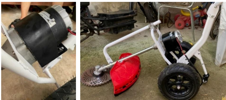
ภาพที่ 6 แสดงตำแหน่งการติดตั้งมอเตอร์ไฟฟ้ากระแสตรงเข้ากับเครื่องตัดหญ้า
