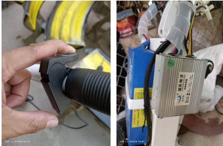
ภาพที่ 9 แสดงลักษณะการติดตั้งสวิตช์ควบคุมความเร็ว และการติดตั้งกล่องคอนโทรล
