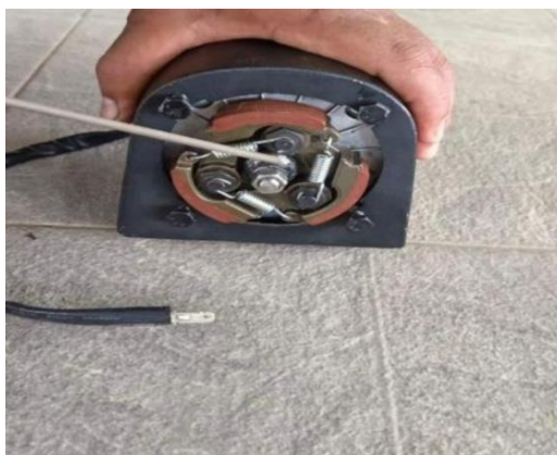
ภาพที่ 5 แสดงการติดตั้งชุดคลัทช์เข้ากับแกนเพลลาของมอเตอร์และการแถมเชื่อมต่อไฟฟ้า
