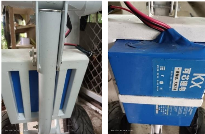
ภาพที่ 7 แสดงลักษณะชุดรองรับแบตเตอรี่และการติดตั้งแบตเตอรี่
