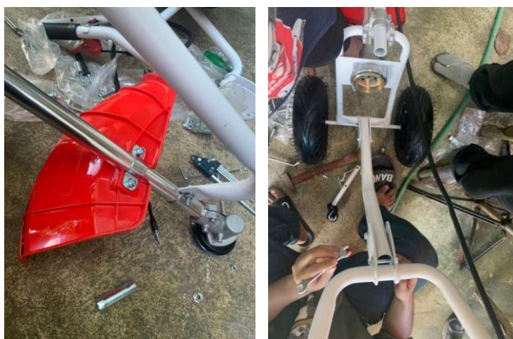
ภาพที่ 3 แสดงลักษณะชุดโครงสร้างของเครื่องตัดหญ้าชนิดเข็นเดินตาม
