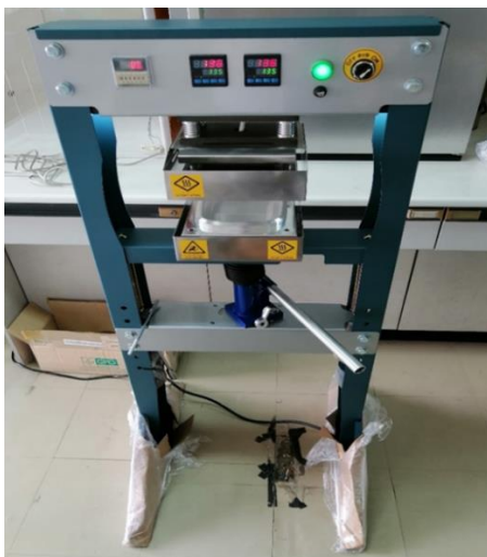
ภาพที่ 7 เครื่องอัดขึ้นรูปภาชนะใส่อาหารจากวัสดุธรรมชาติ
