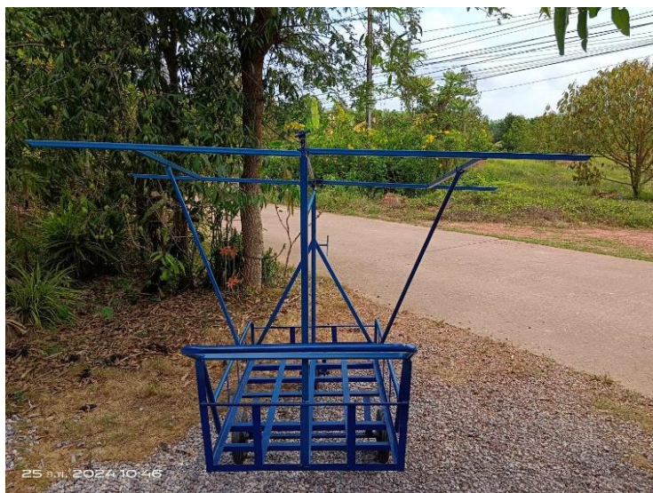
ภาพที่ 2 การจัดสร้างชุดเสารับน้ำหนักแบบพับเก็บได้ และการพันสีกันสนิม
