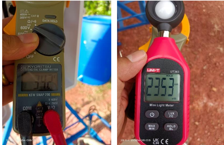
ภาพที่ 6 แสดงการวัดผลค่าแรงดันไฟฟ้าและค่าความเข้มแสง
