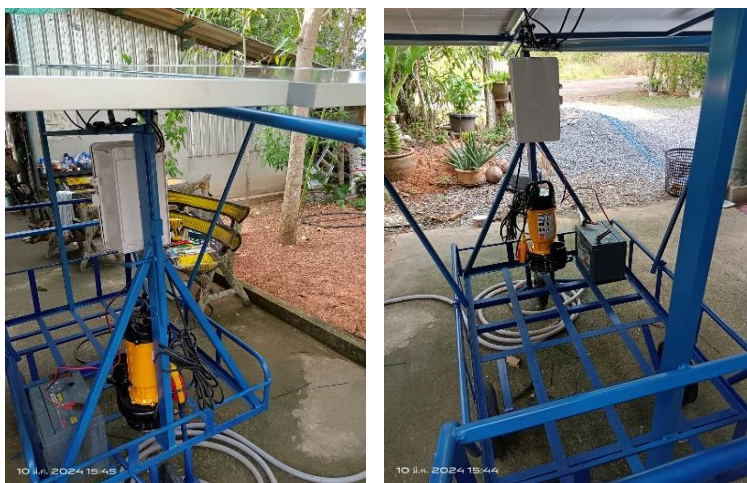
ภาพที่ 3 แสดงการติดตั้งอุปกรณ์ที่สำคัญเข้ากับชุดรถเข็นแผงโซลาร์เซลล์
