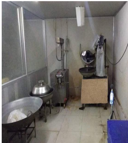
ภาพที่ 2 การติดตั้งอุปกรณ์ป้องกันเสียง และการตรวจวัดเสียงจากวัสดุดูดซับเสียงกลบ ขุยมะพร้าว และฟางข้าว
