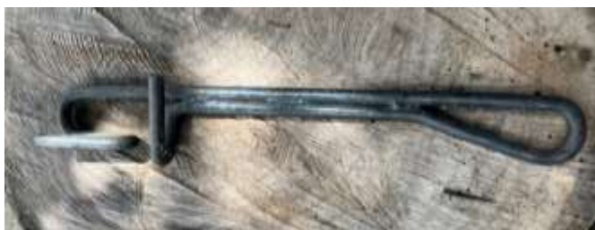
ภาพที่ 8 แสดงเครื่องมือพันลวดเหล็กสายยึดโยงเสาไฟฟ้าที่พ่นสีเรียบร้อยแล้ว
