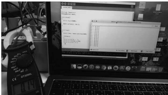
ภาพที่ 3 จากการอ่านค่ากระแสจากแอมมิเตอร์หลังจาก Calibrate
