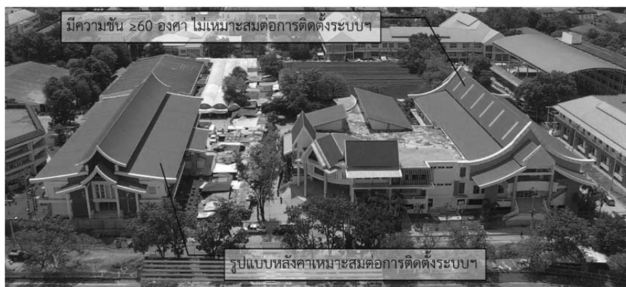
ภาพที่ 7 แสดงลักษณะหลังคาที่เหมาะสมและไม่เหมาะสมต่อการติดตั้งระบบฯ ของอาคารภายในมหาวิทยาลัย เทคโนโลยีอนาคตและความเปลี่ยนแปลงที่มหาวิทยาลัยจะต้องเตรียมรับมือ
