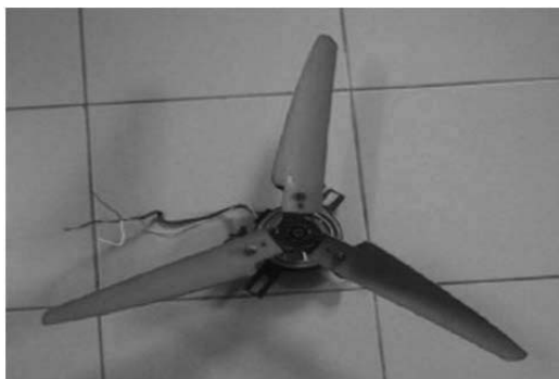
ภาพที่ 17 นำใบพัดที่ได้จากท่อ PVC ประกอบเข้ากับดุม
