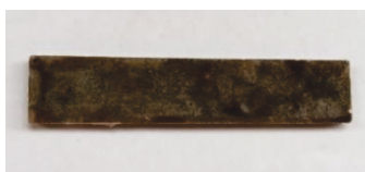
ภาพที่ 7 ชิ้นงานสำหรับการทดสอบความต้านทานแรงกระแทก
