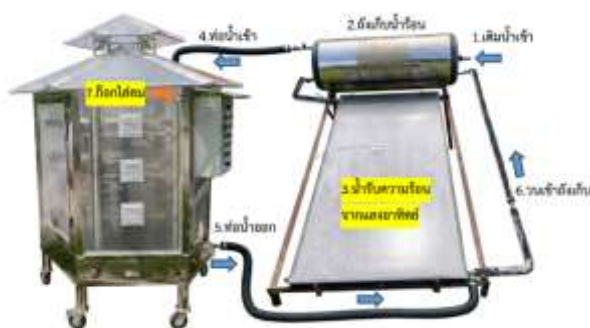
ภาพที่ 3 การออกแบบระบบของตู้อบแห้งร่วมกับโซล่าคอลเลคเตอร์
