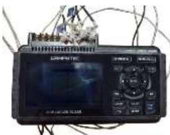
ภาพที่ 4 แสดงเครื่องมือวัดอุณหภูมิ ยี่ห้อ Graphtec รุ่น GL220
