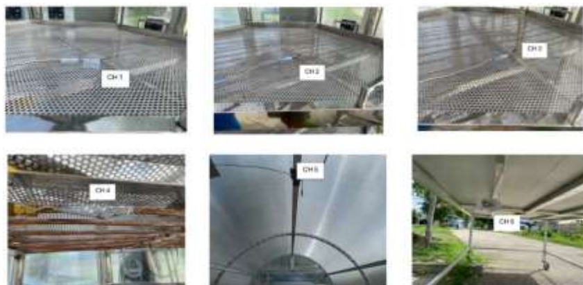
ภาพที่ 5 แสดงตำแหน่งจุดติดตั้งจริงเซ็นเซอร์วัดอุณหภูมิเพื่อบันทึกผลการทดลอง
