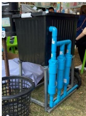
ภาพที่ 4 เครื่องต้นแบบระบบบำบัดน้ำเสียสำหรับสถานประกอบการ
