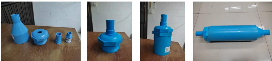
ภาพที่ 5 การออกแบบกระบอกใส่ตัวดูดซับ
