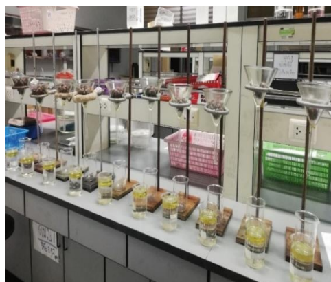
ภาพที่ 7 ชุดทดสอบการศึกษาประสิทธิภาพการดูดซับน้ำมันของถ่านไม้และดินเบา
