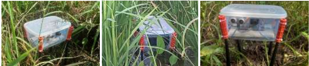
ภาพที่ 6 การติดตั้งชุดตรวจจับเพลี้ยกระโดดสีน้ำตาลด้วยระบบสมองฝังตัวในแปลงนา ทั้ง 6 ตำบล
